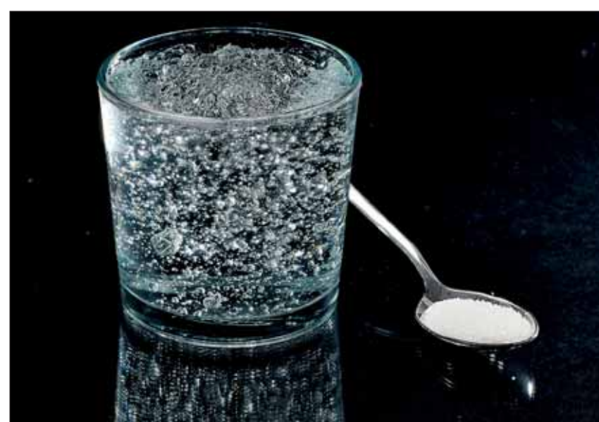
Abbildung 2 Volumenzuwachs nach Hydrierung, rechts Ausgangszustand
